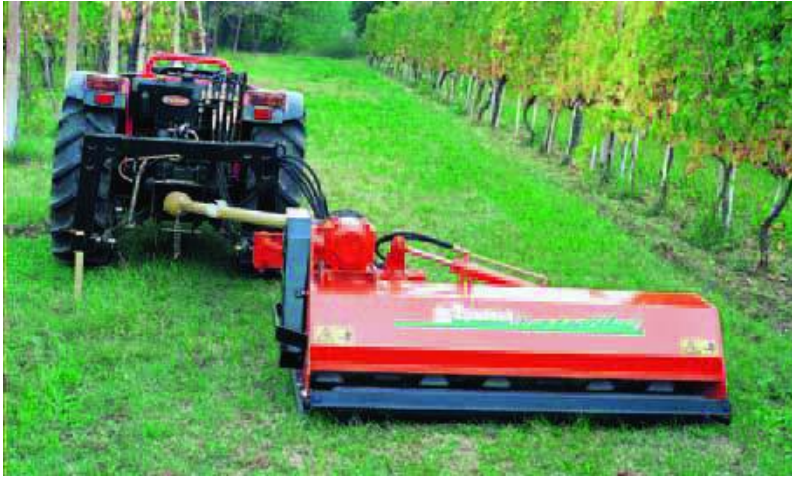
სურ. 3.17. მცენარეთა რიგთაშორისების დამცავი ზოლის დამამუშავებელი აგრეგატი
