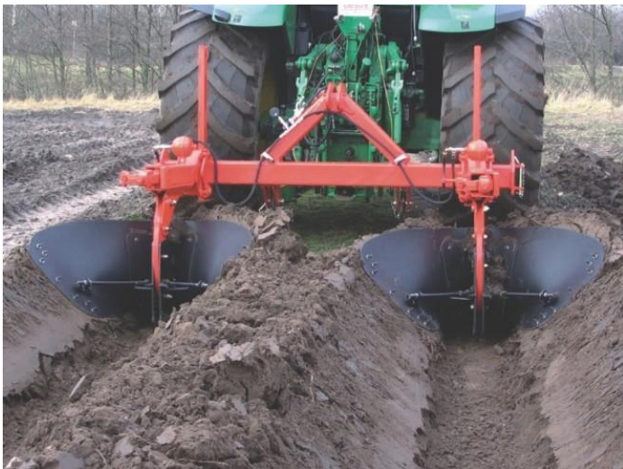
სურ. 3.11. მასიური სფერული კვლების წარმოქმნელი სატრაქტორო აგრეგატი
