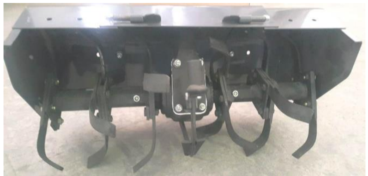
ნახ.16 ფრეზის დამცავი კარტერი და დამაფიქსირებელი ჭანჭიკები
