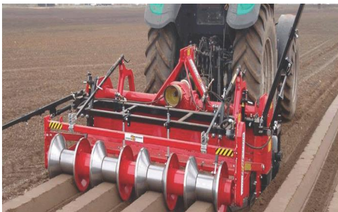
სურ. 3.10. ბაზოწარმომქმნელი კომბინირებული აგრეგატი
