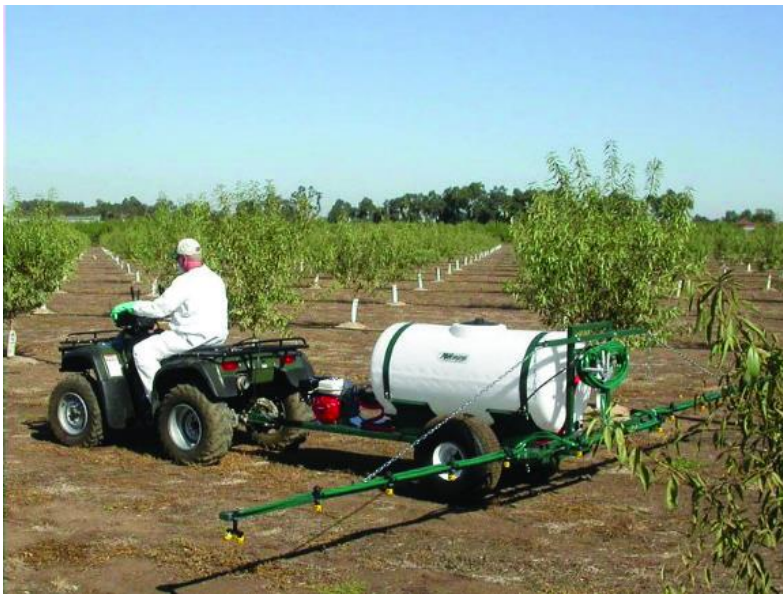
სურ. 3.18. აღმეტური ბაღებისათვის განკუთვნილი მინიტრაქტორზე დააგრეგატებული შემასხურებელი მანქანა
