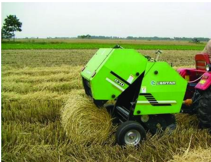
სურ. 3.20. მრგვალი ბარდანების დამამზადებელი მცირეგაბარიტიანი აგრეგატი
