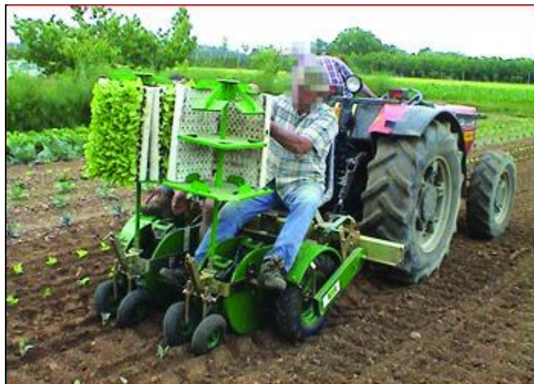
სურ. 3.15 მცირეკონტურიანი ნაკვეთებისათვის განკუთვნილი ჩითილსარგავი კომბინირებული მანქანა.
