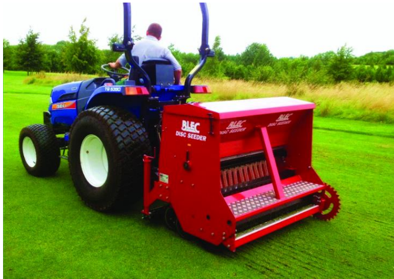
სურ. 3.14. მცირეკონტურიანი ნაკვეთებში ბალახის სათესი კომბინირებული მანქანა
