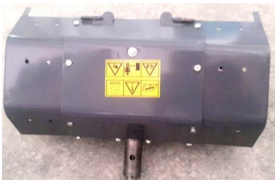
ნახ.16 ფრეზის დამცავი კარტერი და დამაფიქსირებელი ჭანჭიკები
