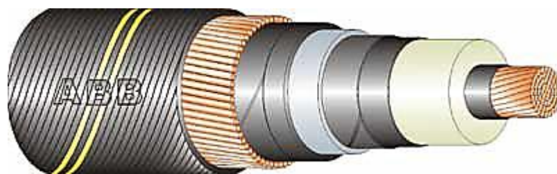
ABB-ს ფირმის XPLE ტიპის ერთძარღვა კაბელი, წყალქვეშა რგოლისებრი დენგამტარებით
