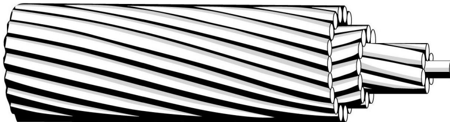
ნახ. 5.7 AAC, ACAR, ACSR, ACSR/AW, ACSS, ACSS/AW ტიპების მრგვალსადენიანი ალუმინის და ალუმინ-ფოლადის გამტარები
