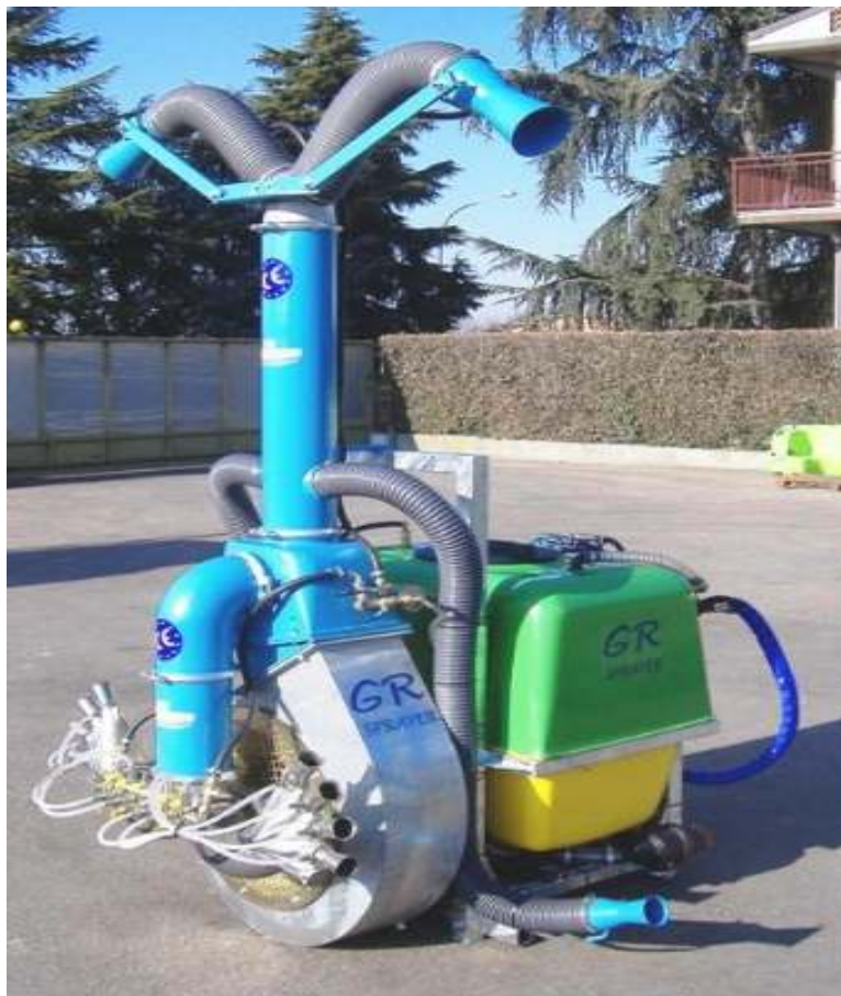
სურ. 137. მცირემოცულობითი შემსხურებელი “Gamberini-Sprayer-A-133”(იტალია)
