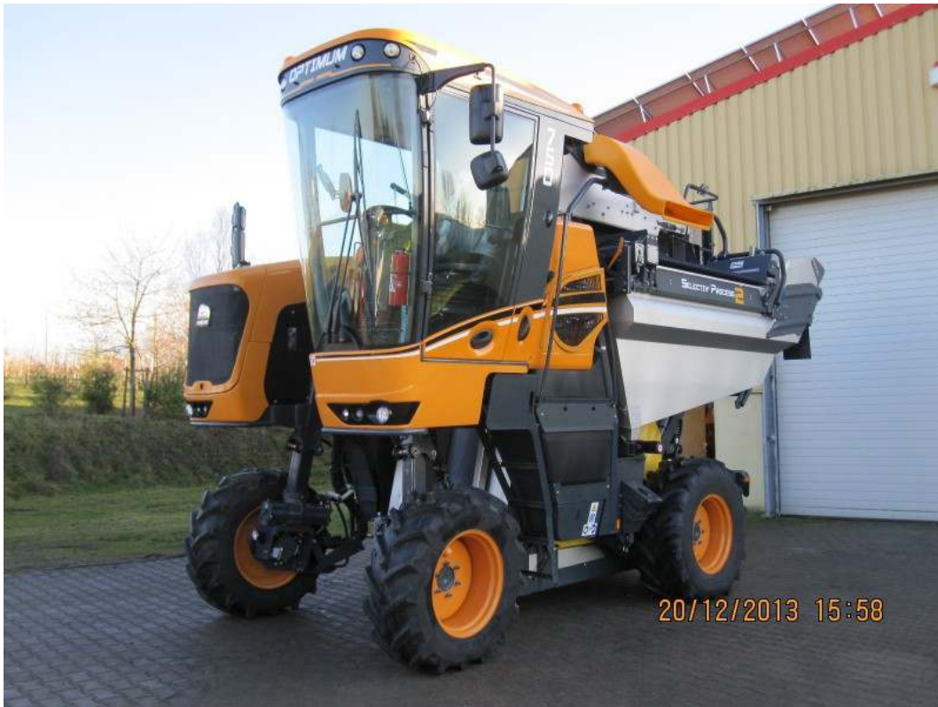
სურ. 150. ეურძნის სკრეფი კომბაინი Optimum (იტალია)
