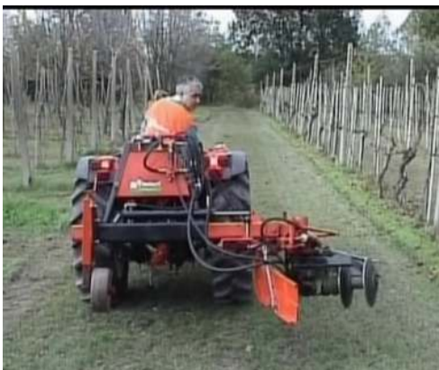
სურ. 135. ვენახის საცავი ზოლების დასამუშავებელი ცალმხრივი მოქმედების მანქანა “Velox 2-Rainer” (იტალია). საბრუნო სამუშაო ორგანო დისკოებიანი იარაღი.
