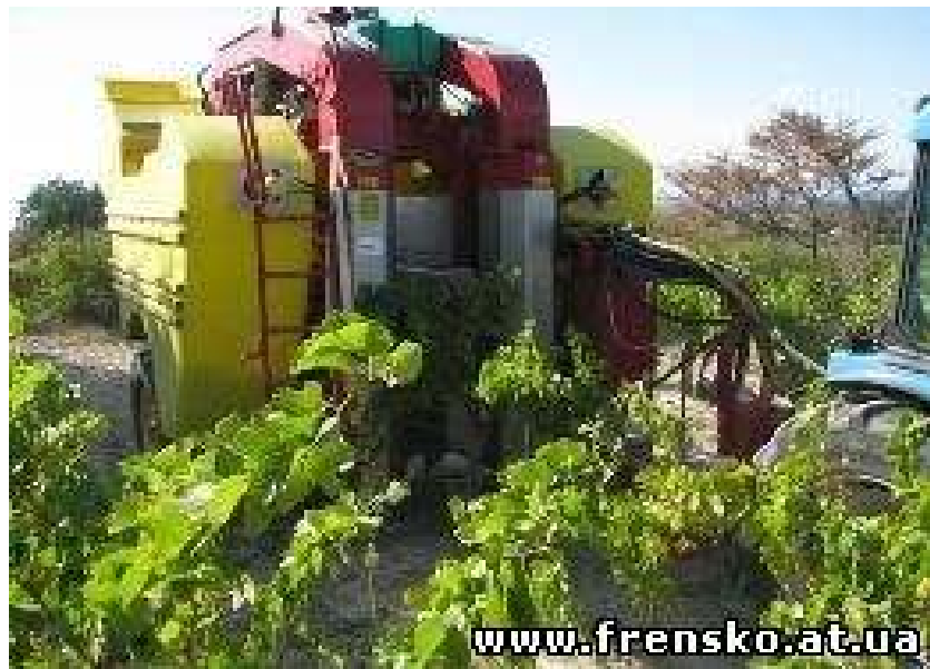
სურ. 149. ყურძნის საკრეფი კომბაინი Frensko (საფრანგეთი)
