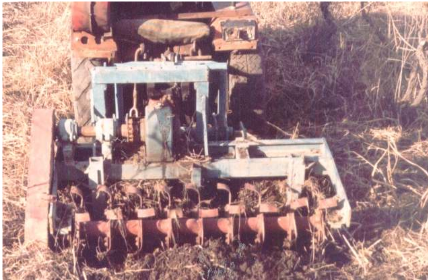
სურ. 84. ვენახის რიგთაშორისებში ნიადაგის დასამუშავებელი ფრეზა-კულტივატორი მუშაობაში
