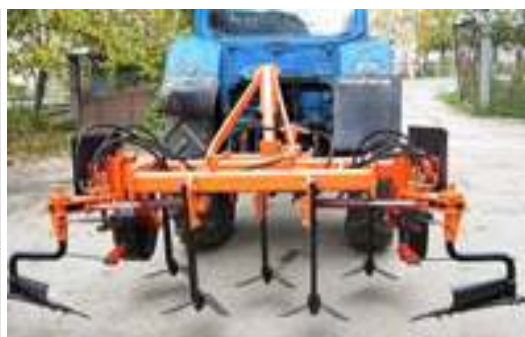
სურ.132 ვენახის საცავი ზოლების დასამუშავებელი მანქანა "KHB 3" (უკრაინა, ქ. ოდესა)
