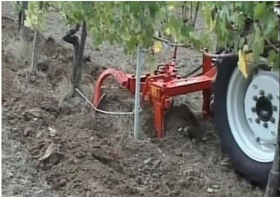
სურ. 134. ვენახის საცავი ზოლების დასამუშავებელი ცალმხრივი მოქმედების მანქანა “AI/15-Rainer” (იტალია). საბრუნო სამუშაო ორგანო მცირე ზომის გუთნის კორპუსი.
