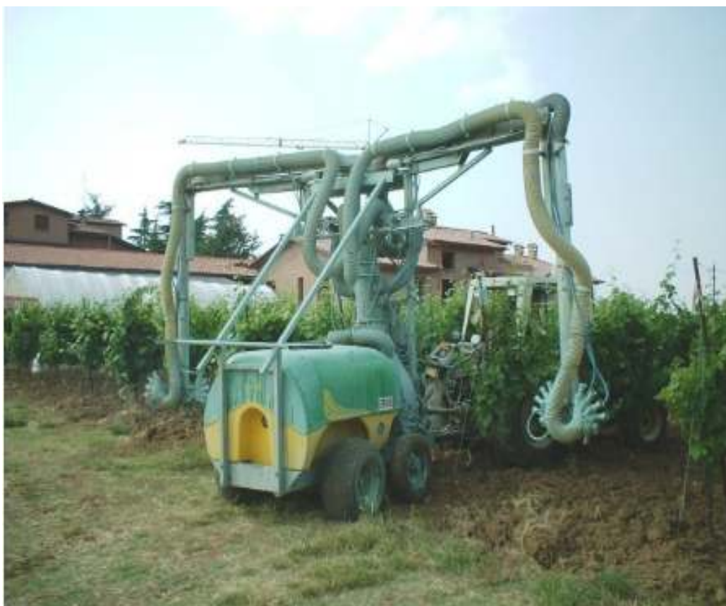
სურ. 140. მცირემოცულობითი შემსხურებელი "Gamberini-Sprayer- A-133"(იტალია)
