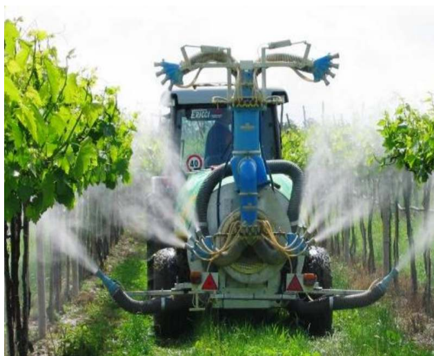
სურ. 139. მცირემოცულობითი შემსხურებელი "Gamberini-Sprayer- A-133"(იტალია)
