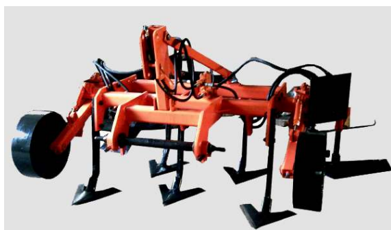
სურ.132 ვენახის საცავი ზოლების დასამუშავებელი მანქანა "KHB 3" (უკრაინა, ქ. ოდესა)
