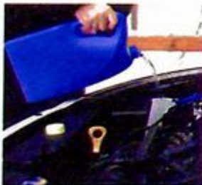
სურ. 2. ანტიფრიზი რადიატორში წყალს იცავს როგორც გაყინვისგან, ასევე დუღილისგან და აორთქლებისგან.
