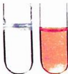
ნახ. 1.17. ბრომის ტესტი: ნაჯერმა ნახშირწყალბადმა ბრომიან ხსნარს ფერი არ შეუცვალა (მარჯვნივ), ხოლო უჯერი ნახშირწყალბადის შემცველ სინჯარაში დამატებული ბრომიანი ხსნარი გაუფერულდა (მარცხნივ).
