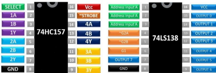
ნახ.5.41. 74 სერიის 74HC157 მულტიპლექსორი (ა) და 74LS138 დემულტიპლექსორი (ბ).
