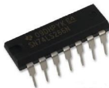
ნახ.1.15. ელემენტი „ჯამი 2-ის მოდულით ინვერსიით“ (XNOR) ა. სქემატური აღნიშვნა ევროპულ და ამერიკულ სტანდარტებში, ბ. ჭეშმარიტების ცხრილი, გ. რეალურ მიკროსქემაში 4 ლოგიკური ელემენტის განლაგება, დ. მიკროსქემის SN74266 ფოტო.
