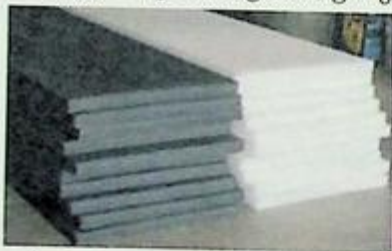
სურ. 5.17. პოლიპროპილენის ბერათსაიზოლაცია მასალა
