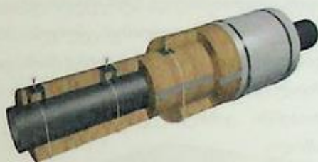
სურ. 5.57. მილსადენის თბოიზოლაცია მინერალური ბამბით
