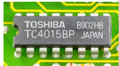
სურ.62.4. Toshiba TC4015BP - 4-თანრიგიანი მიკროპროცესორი. თანმიმდევრობითი შეტანა/პარალელური გამოტანა
