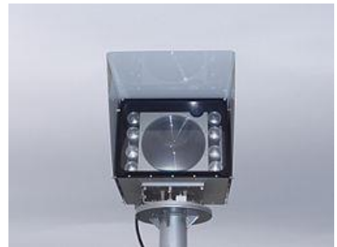
სურ.84.1. 8-სიხვიანი ლაზერული არხი, რომელიც გათვლილია 1 გბიტი/წმ-სიჩქარით ინფორმაციის გადასაცემად. შუაში დიდი ლინზა წარმოადგენს რეცეპტორს, ხოლო გადამცემი მცირე ზომის ლინზის მაგვარი, რომელიც განთავსებულია მარჯვენა ზედა კუთხეში
