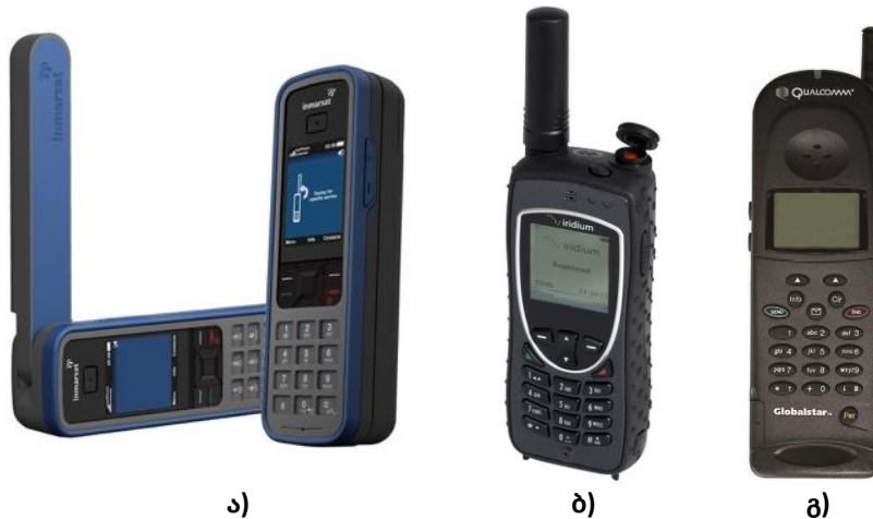
სურ.85.1. ტელეფონები თანამგზავრული კავშირისათვის: ა) Inmarsat, ბ) Iridium Extreme, გ) GlobalStar
