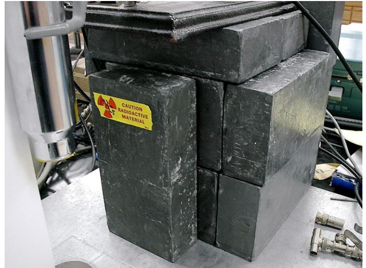
სურათი 9.2. რადიოაქტიურ მასალებისაგან დამცავი მყარი მასალის ბარიერი
