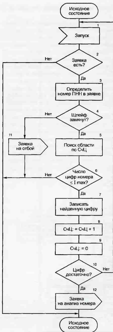
Рис. 2.76. Алгоритм приема цифр
