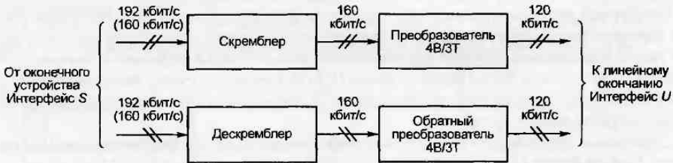
Рис. 1.43. Структурная схема сетевого терминала
