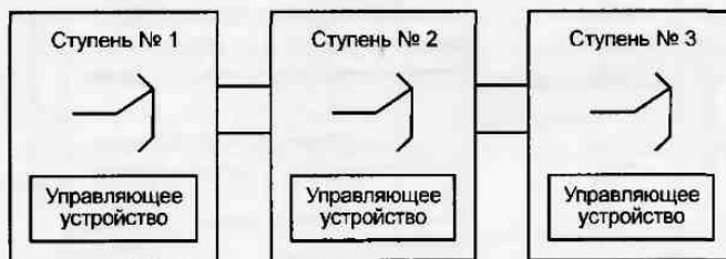
Рис. 2.9. Принцип распределенного по ступеням управления с общим устройством управления на ступень
