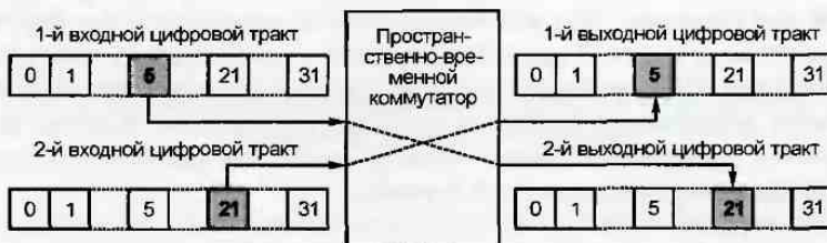
Рис. 2.43. Принцип пространственно-временной коммутации
