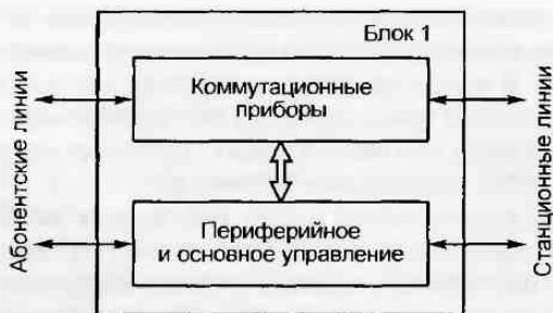
Рис. 2.15. Блок системы с децентрализованным управлением
