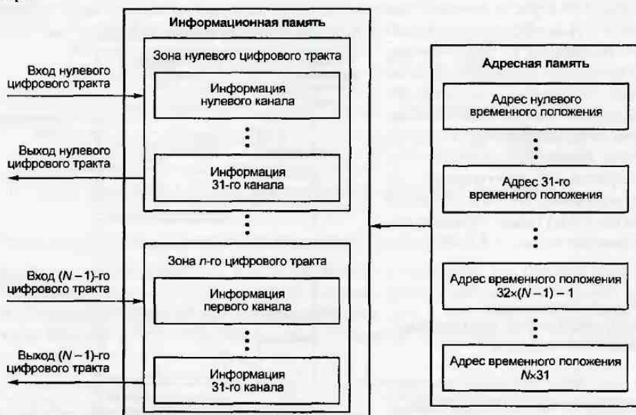
Рис. 2.46. Реализация пространственно-временной коммутации на базе запоминающего устройства ( N цифровых трактов по 32 временных положения в каждом)
