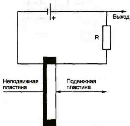
Рис. 1.9. Внутренняя схема конденсаторного микрофона
