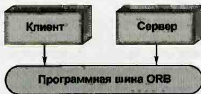
Рис. 2.95. Фрагмент архитектуры CORBA
