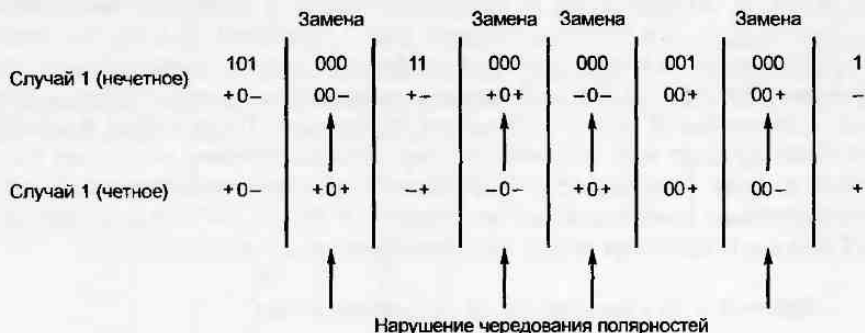
Рис. 1.31. Пример замены последовательностей из трех нулей
