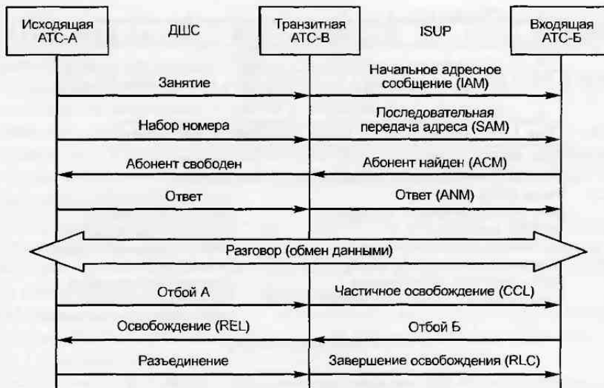
Рис. 2.115. Обмен сигналами при установлении входящего соединения от декадно-шаговой системы к системе с сигнализацией по ОКС
