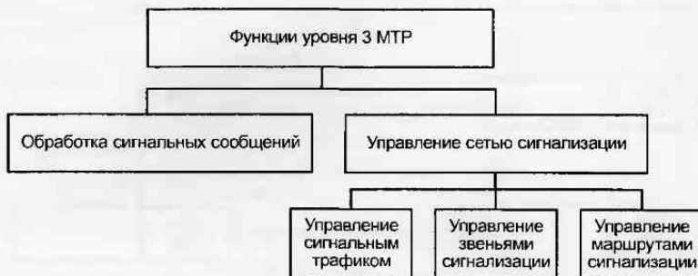
Рис. 2.120. Функции управления сетью сигнализации и восстановления звена данных
