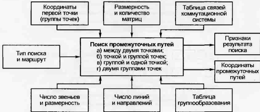
Рис. 2.83. Структурная схема алгоритма поиска путей
