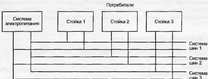
Рис. 2.133. Радиальная система разводки электропитания
