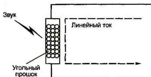
Рис. 1.7. Принцип построения угольного микрофона
