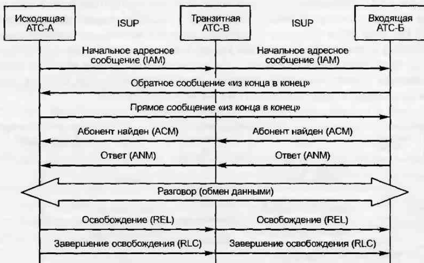
Рис. 2.113. Обмен сигналами при установлении и разъединении соединения
