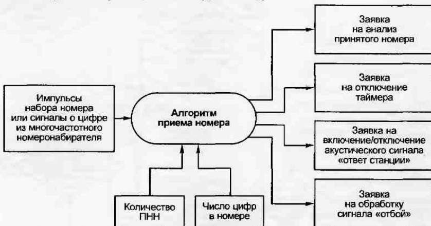
Рис. 2.74. Функциональная схема приема номера
