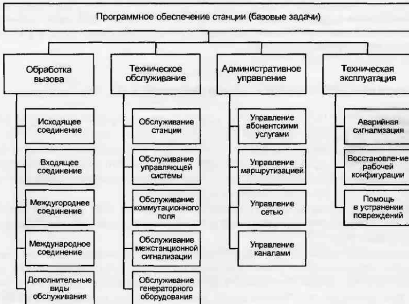
Рис. 2.104. Пример структурной схемы программного обеспечения АТС
