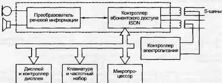
Рис. 1.46. Основные составляющие телефонного терминала ISDN
