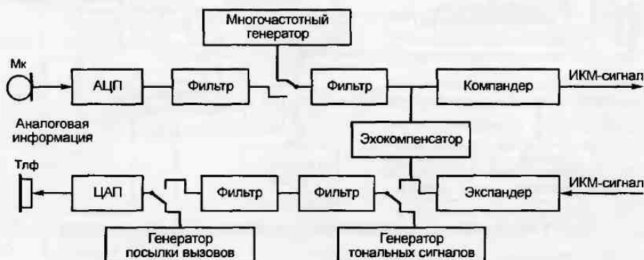
Рис. 1.47. Структурная схема преобразователя речи
