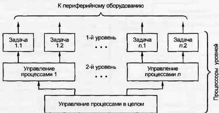
Рис. 2.14. Иерархический принцип управления
