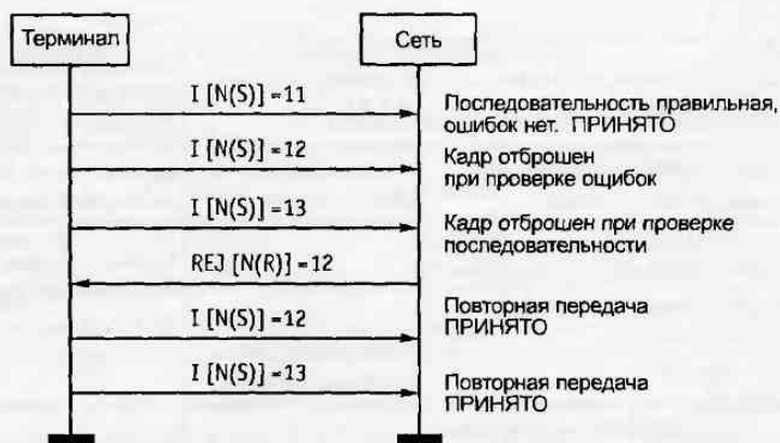
Рис. 1.61. Исправление ошибок в информационном кадре
