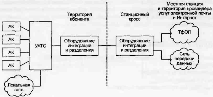
Рис. 1.23. Сеть абонентского доступа с разделением потоков
