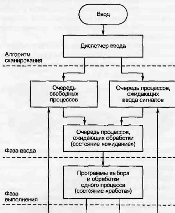
Рис. 2.100. Порядок многозадачной обработки процессов и взаимодействие очередей
