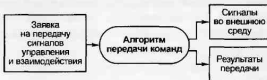
Рис. 2.89. Структура алгоритма приема и передачи сигнальной информации
