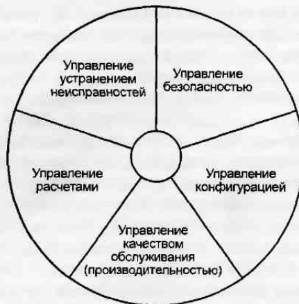
Рис. 3.40. Классификация функций уровней управления сетью
