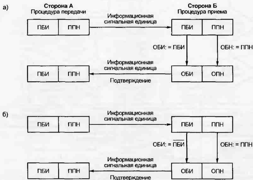
Рис. 2.92. Принцип подтверждения и переспроса сигнальных единиц: а) подтверждение в случае правильного приема сигнальной единицы; б) переспрос в случае неправильного приема сигнальной единицы (инверсия прямого бита индикатора)
