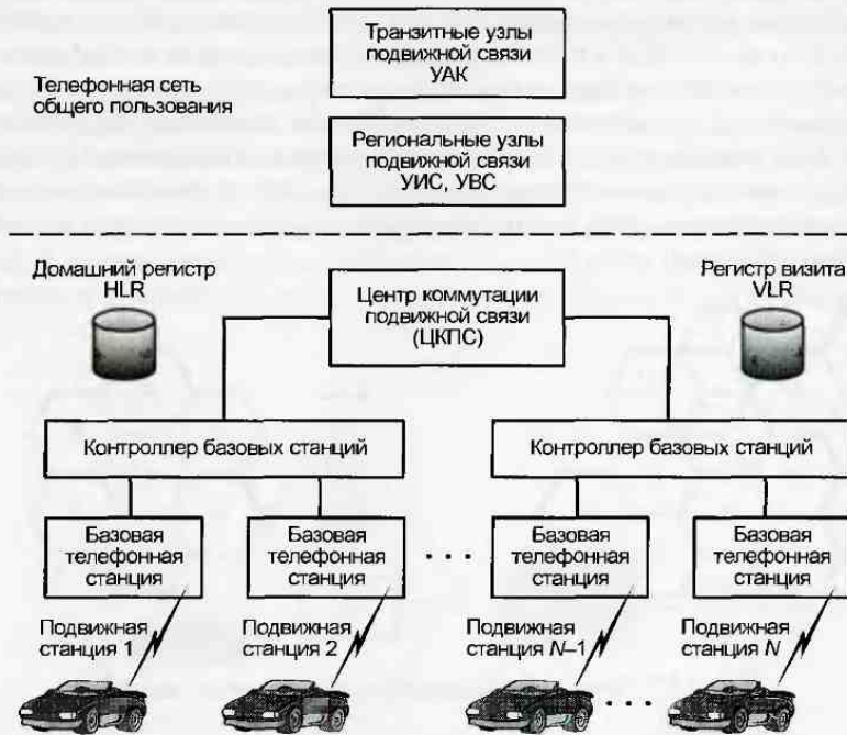
Рис. 3.18. Принцип построения сотовой мобильной сети:
