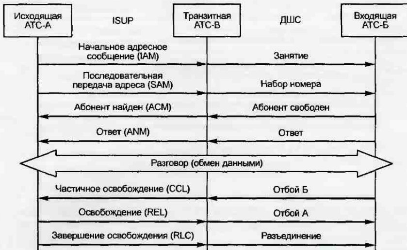
Рис. 2.114. Обмен сигналами при установлении входящего соединения от системы с сигнализацией по ОКС к декадно-шаговой системе (ДШС)
