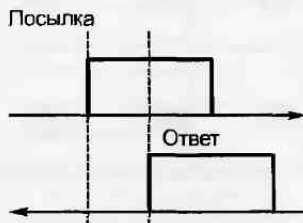
Рис. 2.125. Принцип посылки импульса без использования тактового генератора
