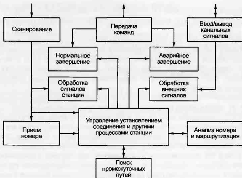
Рис. 2.63. Структурная схема алгоритмического обеспечения
