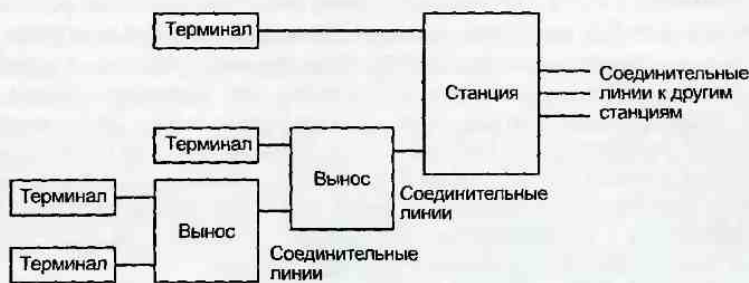
Рис. 1.22. Многоступенчатое включение выносных блоков
