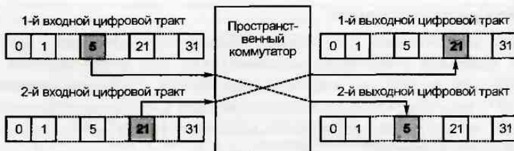
Рис. 2.42. Принцип пространственной коммутации
