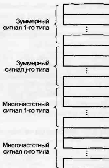
Рис. 2.130. Накопитель акустических и многочастотных сигналов
