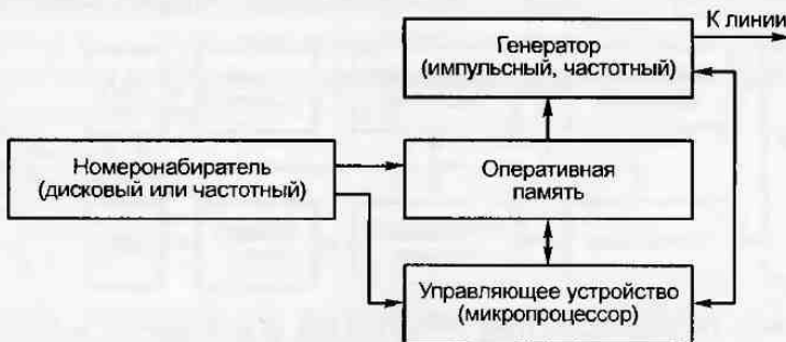
Рис. 1.16. Структурная схема устройств запоминания и выдачи номера
