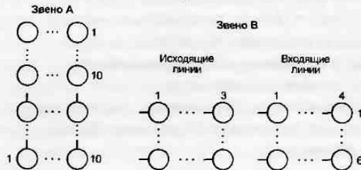
Рис. 2.30. Группообразование ступени абонентского искания 100×60×40 (20 исходящих и 20 входящих линий) без транспонирования: а) построение блока; б) схема группообразования
