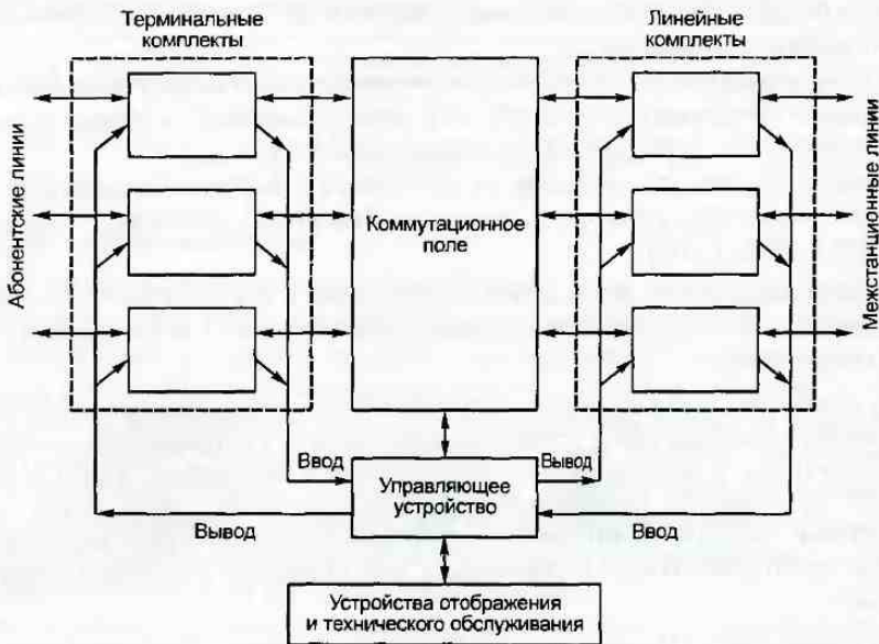
Рис. 2.1. Общая структура станции, предназначенной для коммутации и обработки информации
