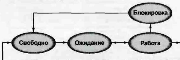
Рис. 2.99. Последовательность значений глобальных состояний вызова
