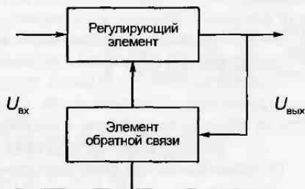
Рис. 2.139. Принцип построения стабилизатора постоянного тока
