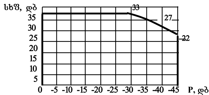
სურ. 2.9. სიგნალი/(დაკეანტვის ხმაური) ფარდობის (სსშ) სიგნალის დონეზე დამოკიდებულება
