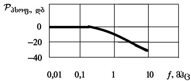
სურ. 1.17. ამწონი ფილტრის სიხშირული მახასიათებელი შავ-თეთრი ტელევიზიისათვის
