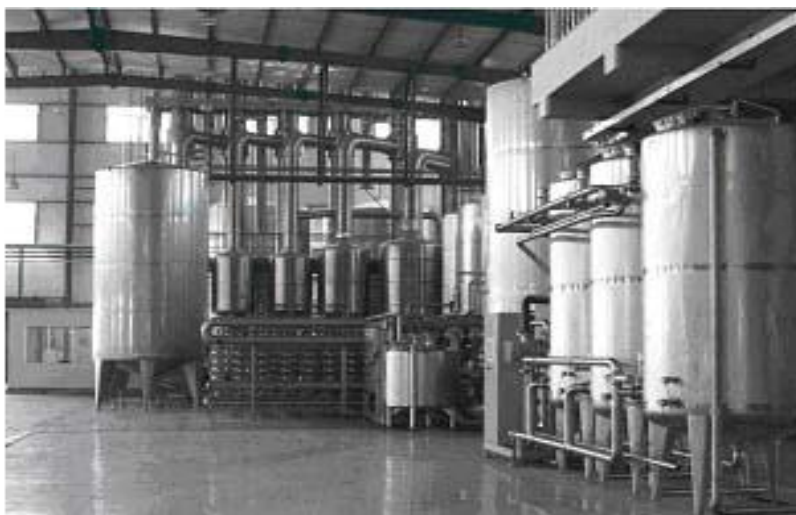
Линия переработки яблочного сока с ультрафильтрацией, ароматоулавливателем и вакуумно-выпарной установкой, станцией безразборной мойки (CIP)
