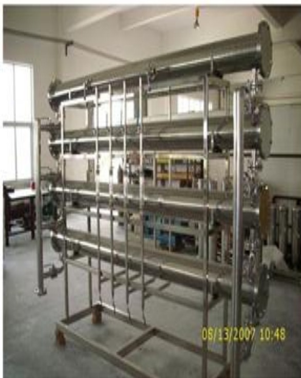
ნახ.19 ულტრაფილტრაციული სპირალური საწარმოო სისტემა UF-812 ელემენტებით ST3B
