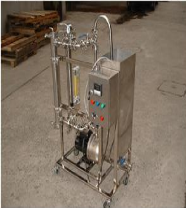
ნახ.16 ულტრაფილტრაციული სპირალური პილოტური სისტემა UUF – 201
