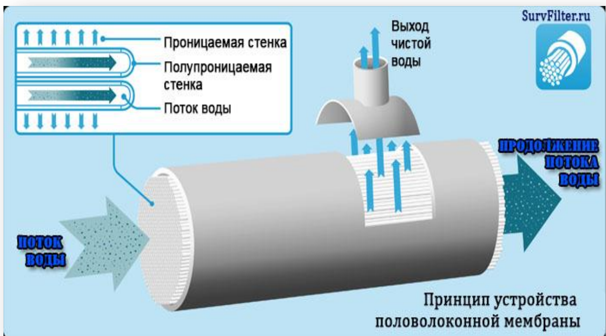
ნახ.8 ღრუ ბოჭკოებში მიმდინარე ულტრაფილტრაციული პროცესის სქემა
