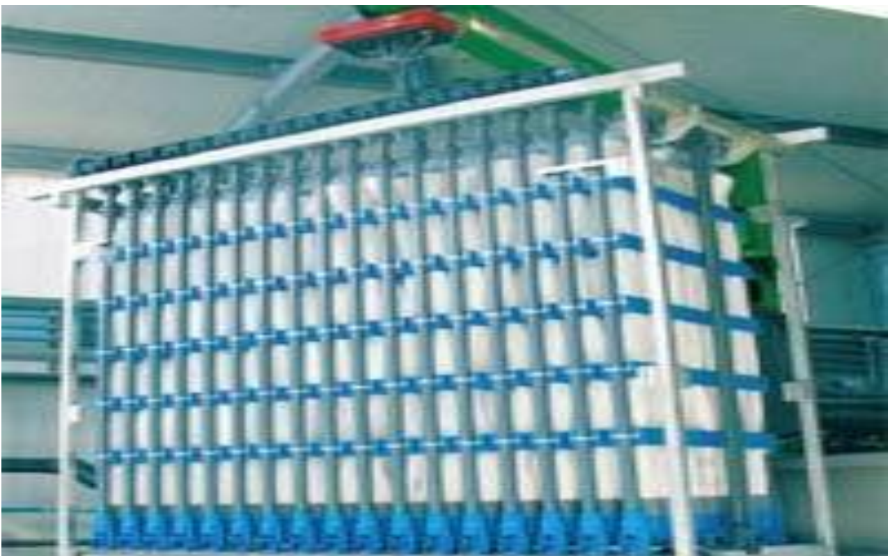
ნახ.32 ჩაძირული მოდული რულონისებრი მემბრანული ელემენტებით
