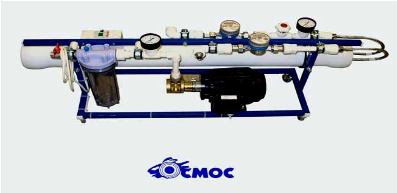
ნახ.65 გაწმენდილი წყლის მიღების ორსაფეხურიანი სისტემა ფარმაცევტულ ქარხანაში "РОСБИО" (რუსეთი).
