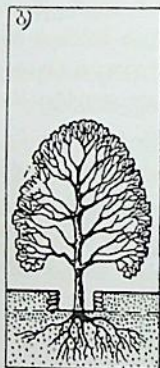
სურ. 11. ხეების დაცვა ნაკვეთებზე, სადაც გრუნტი იშლება ა—გზის მონაკვეთზე ხის ირგვლივ დახურული საცავის მონყობა; ბ—იგივე, ქვებით და ფილებით მონყობა
