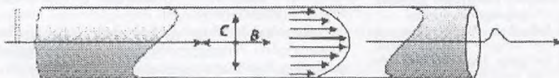
ნახ.1.16. ქრომატოგრაფიული ზოლის დიფუზიური გაფართოება B -გრძივი დიფუზია, C -რადიალური დიფუზია
