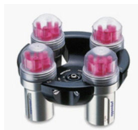
სურ. 9 ბაკეტროტორები თავისუფლად ჩამოკიდებული სინჯარებით
