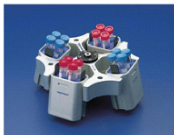
სურ. 9 ბაკეტროტორები თავისუფლად ჩამოკიდებული სინჯარებით
