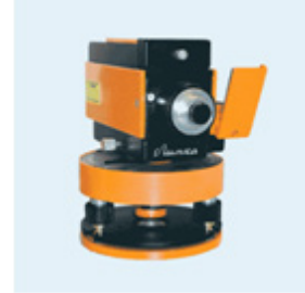
ნახ. III.38 ნიველირები კომპენსატორით ა - ტექნიკური H-10 კ/ლ 1-ხუფი; 2- სარკე; 3 - ოკულიარი; 4 - მიმართველი ხრახნი; 5 - ფანჯარა ჰორიზონტალურ წრის შეკლიდან ანათელის ასაღებად; ბ - ზუსტი ნიველირი 3H-2კ/ლ ქანქარისებური მაგნიტურ- ოპტიკური კომპენსატორით;
