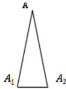
ნახ. V. 20. ჭოგრის ჰორიზონტალური ღერძისა სახაზავის ქვედა სიბრტყის ცლომილება
