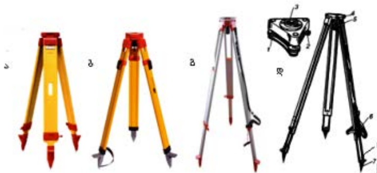
ნახ. III. 24. შტატივები: ხის ა (თეოდოლიტის) - და ბ - (მსუბუქი, ნიველირისთვის). გ - მეტალის; დ - ტრეგერისა და შტატივის ძირითადი ნაწილები: 1-ფირფიტა; 2 - ტრეგერის სამაგრი ხრახნი; 3-; 4-შტატივის თავი; 5 - ხერხემლის ხრახნი; 6 - მოსაჭერი და სამხრე თასმა; 7- წვერი; 8 - მბჯენი;
