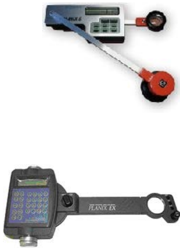
ნახ. VII. 5. ელექტრონული პლანიმეტრები ა – პოლარული ტიპის PLANIX 5 ბ – საკისრებიანი ტიპის PLANIX EX 7
