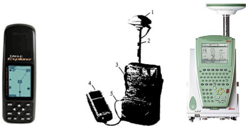
ნახ. IV. 15. ერთსიხშირიანი 12 არხიანი „GPS“-მიმღებები: ა) ნავიგაციური კლასის სიზუსტის „Eagle Explorer“; ბ) კარტოგრაფიისა და GIS კლასის „Pathfinder ProXI“ - 1-კომპაქტური ანტენა გარსედიანით; 2 - ნახევარმეტრიანი ნაკრები დგამი; 3- სისტემის გადასატანი ჩანთა; 4-TDCI-ის ამგროვებელი; 5-მონაცემთა ჩატვირთვის კაბელი; გ) გეოდეზიური კლასის Leica Geosystems
