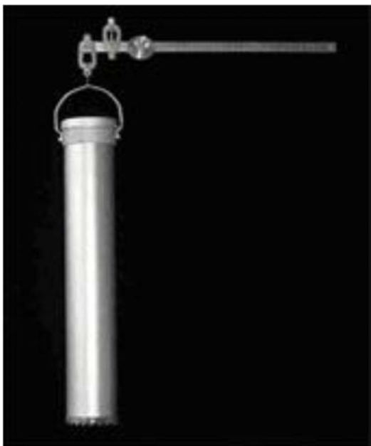
ნახ.11.3.7. წონითი თოვლსაზომი BC-4 , საერთო ხედი
