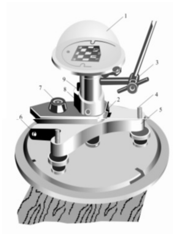
ნახ.11.1.4. უნივერსალური პირანომეტრი, თერმოელექტრული M-80M: 1 - პირანომეტრული თავსახური; 2 - საკეტი ზამბარა; 3 - დამაჩრდილებელის სამაგრი; 4 - ამწე ხრახნი; 5 - სტენდი; 6 - დასაკეცი ნაწილი; 7 - დონე; 8 - ხრახნი; 9 - საყრდენი
