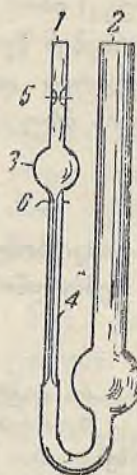
სურ. 47. კაპილარული ვისკოზიმეტრი; 1, 2—შემაერთებელი მილები; 3—გაფართოება; 4—კაპილარული მილი; 5, 6—ნიშნები.
