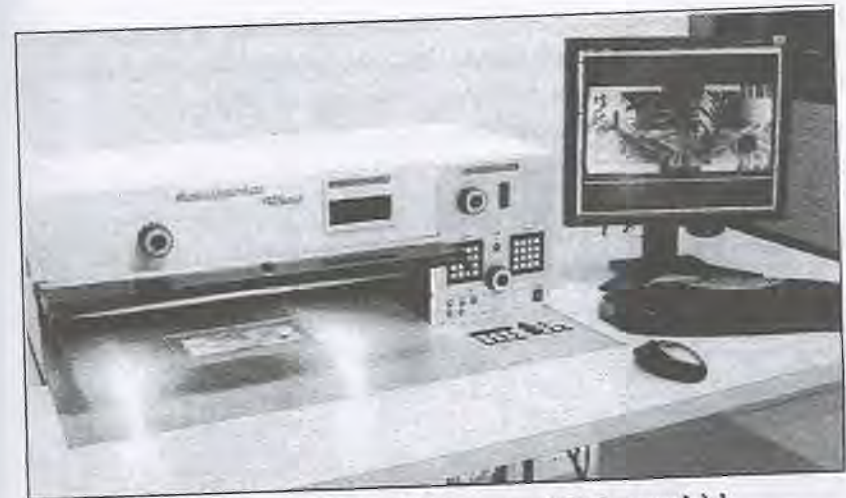
სურ. 16. „დოკუმენტი-4500“-ით დოკუმენტის გაყალბების ნიშნების გრანზე წარმოჩენა
