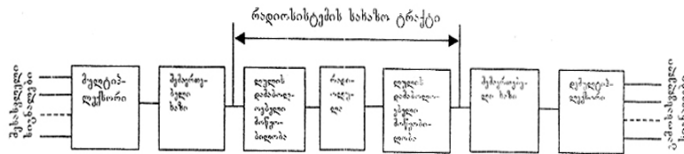
ნახ. 5.8. რადიოსისტემების სტრუქტურული სქემა
