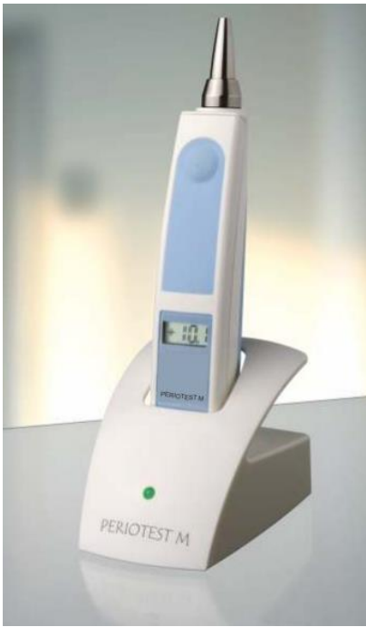
სურ. 62. პაროდონტის ქსოვილთა მდგომარეობის შესაფასებელი მოწყობილობა „პერიოტესტი“
