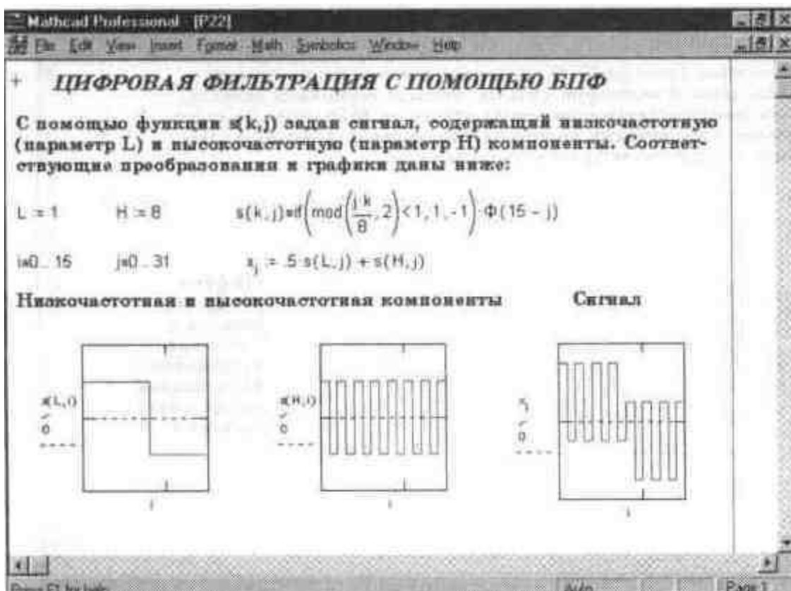
Рис. 14. 29 Реализация цифровой фильтрации (начало документа)
