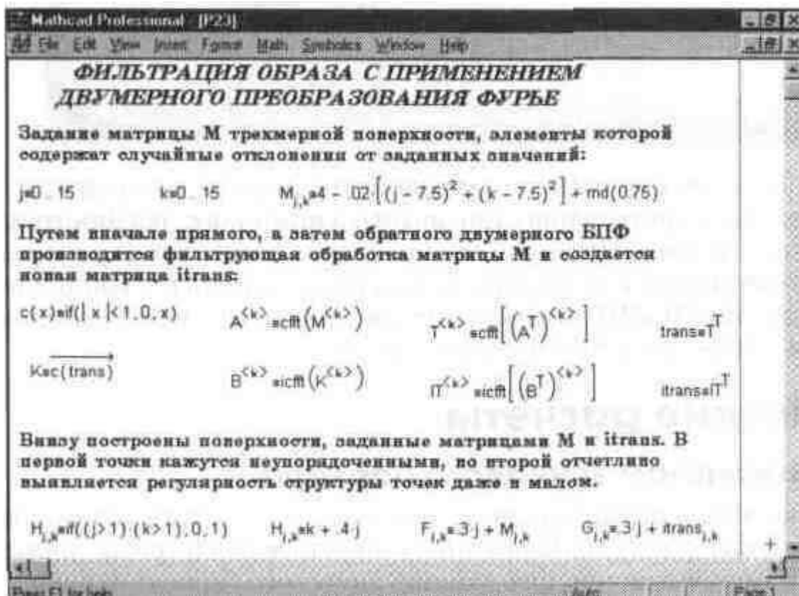
Рис. 14. 31 Фильтрация пространственного образа (начало документа)
