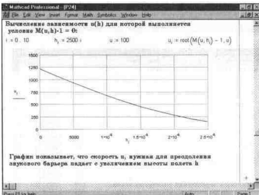
Рис. 14. 34 Расчет скорости преодоления самолетом звукового барьера (конец документа)
