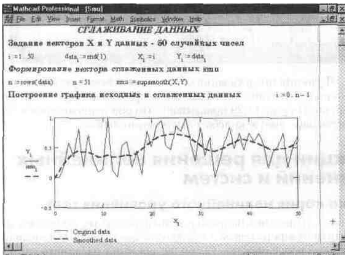
Рис. 11.28 Сглаживание данных, представленных рядом значений X_n Y
