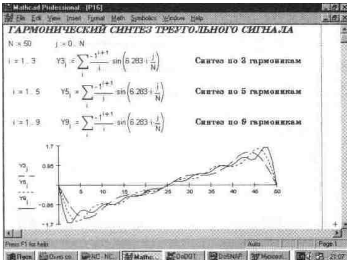
Рис. 14.19 Гармонический синтез треугольных колебаний
