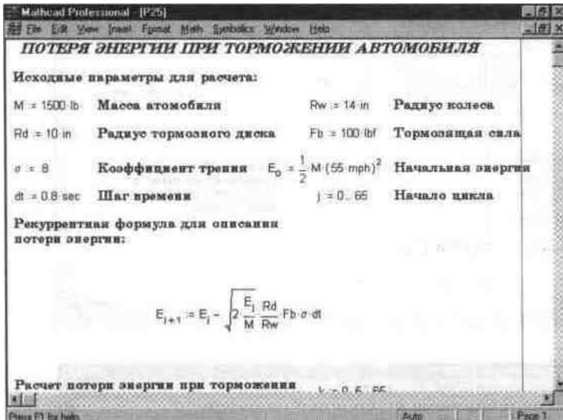
Рис. 14. 35 Расчет потери энергии тормозящим автомобилем (начало документа)
