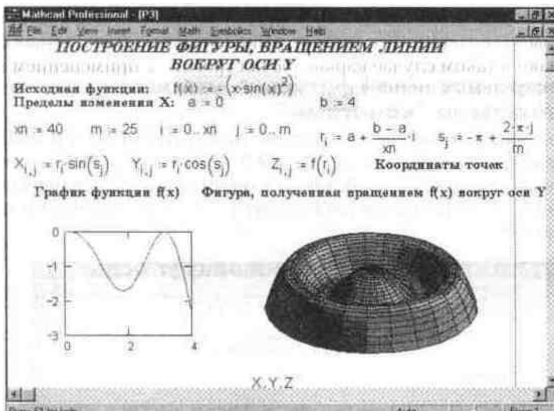
Рис. 14. 3 Построение фигуры вращением линии вокруг оси Y
