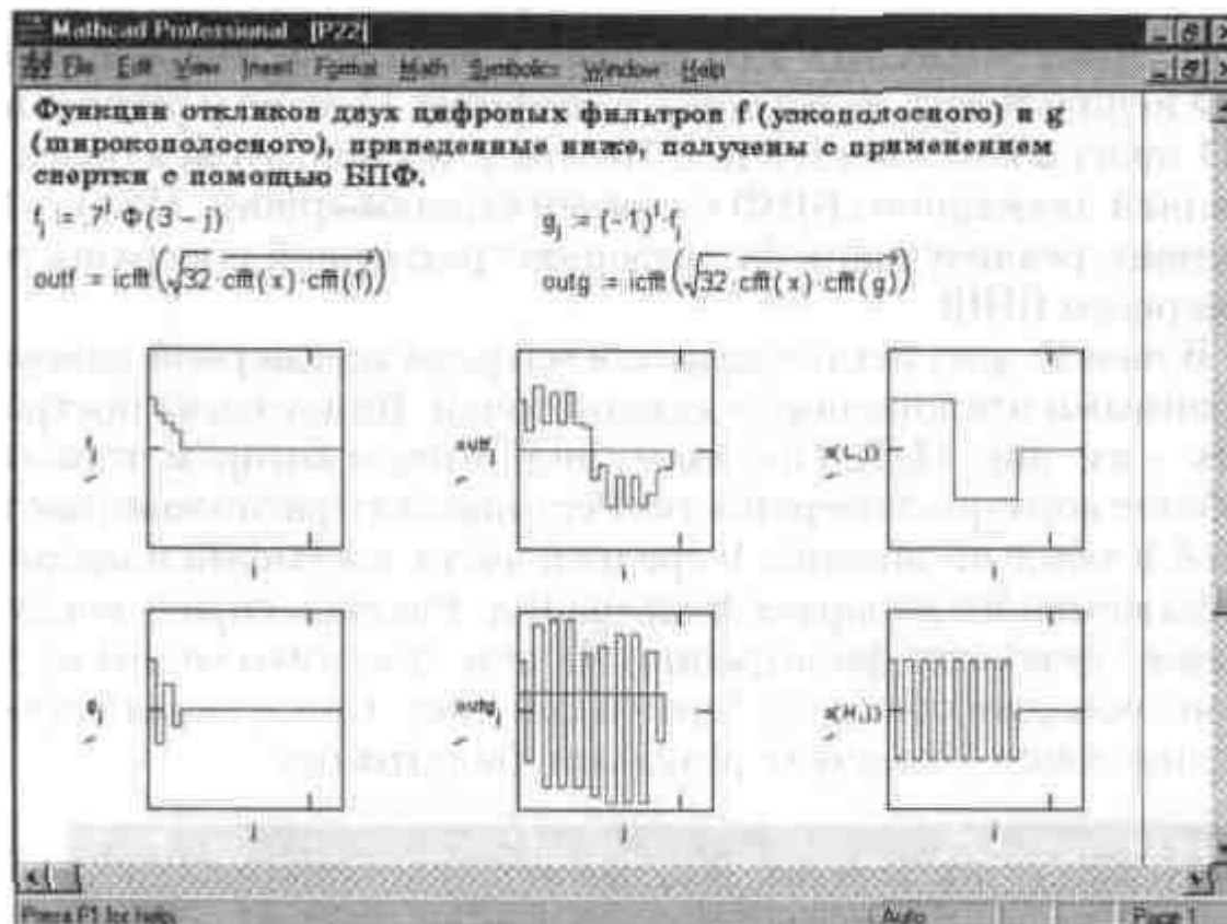
Рис. 14. 29 Реализация цифровой фильтрации (начало документа)
