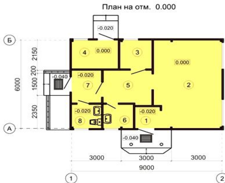
Рис. 12.31г. Планировка здания АЗС
