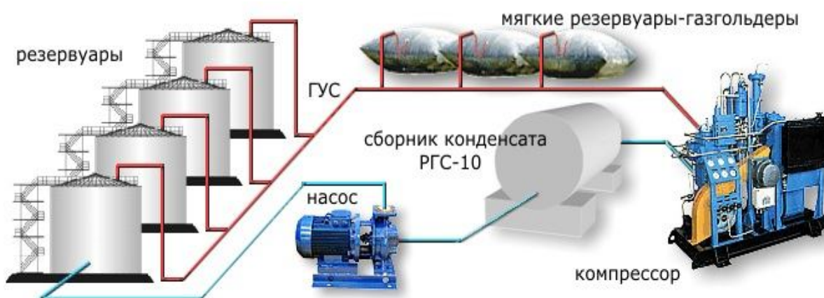
Рис. 14.5. Схема преобразования паровоздушной смеси в жидкость и её возврат в резервуар
