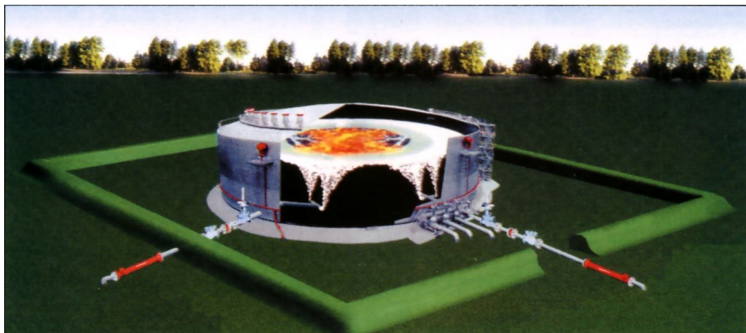
Рис. 10.12. Тушение пожара при помощи пены, автоматически подаваемой на поверхность горящего факела через нефтепродукт, находящийся в резервуаре
