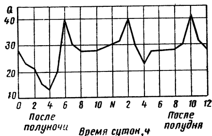
Рис. 15.7. Загрузка Q в течение рабочих суток автомобильной стоянки, обслуживающей промышленное предприятие. Q представляет собой отношение количества одновременно стоящих автомобилей к среднесуточному количеству прибывающих автомобилей на стоянку в процентах
