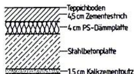
Bild 9.11 Aufbau der Wohnhausdecke von Bild 9.10
