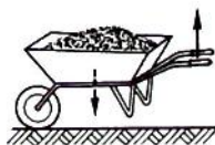
Bild 5.9 Die Schubkarre ist ein einseitiger Hebel
