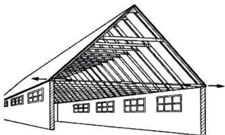
Bild 3.15 Ein Zuganker hält den Dachbin- der zusammen
