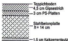
Bild 9.14 Stahlbetondecke in einem Wohnhaus
