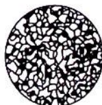
ნახ. 12. მცირენახშირბადიანი ფოლადის მიკროსტრუქტურა
