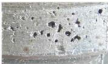
სურ. 34. აირული ნიჟარები (დეტალის ფრაგმენტი)
