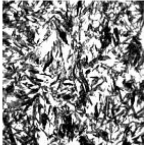
სურ. 86. მარტენსიტის მიკროსტრუქტურა, X500
