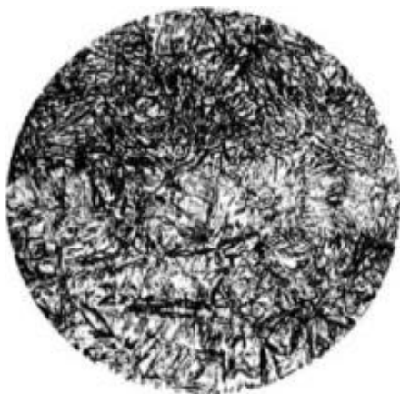
სურ. 83. ბეინიტის მიკროსტრუქტურა
