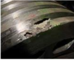
სურ. 37. ქვიშიანი ღია ნიჟარა (დეტალების ფრაგმენტები): ა - გადაჩარხული დეტალი; ბ - დაუმუშავებელი სხმული
