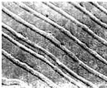
სურ. 81. სორბიტის მიკროსტრუქტურა x7500
