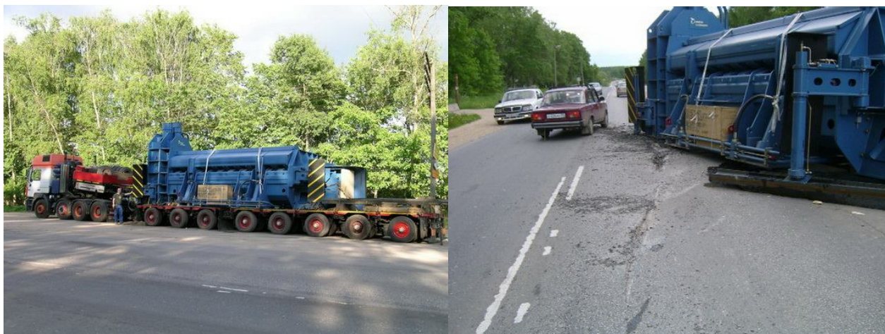
Рис. 4.6. Выпадение 62-тонных механических ножниц на дороге А-102 за счет смещения
