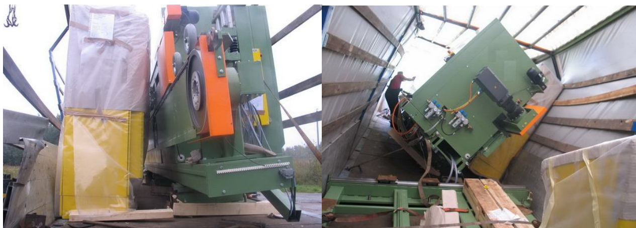
Рис. 4.9 . Опрокидывание слабо закрепленного груза
