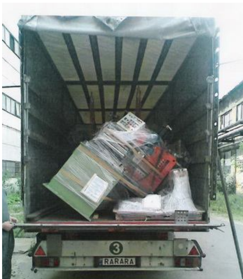
Рис. 4.16. Пример опрокидывания груза со смещенным центром тяжести
