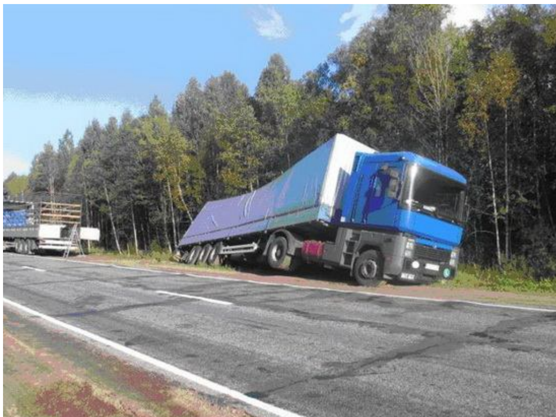
Рис. 4.19. Последствия действия инерционных сил при неправильном креплении грузов на подвижном составе
