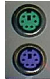
ნახ. 9.1. კონტაქტიანი Mini-DIN გასართები კლავიატურისთვის (იასამნისფერი) და მაუსისთვის (მწვანე)
