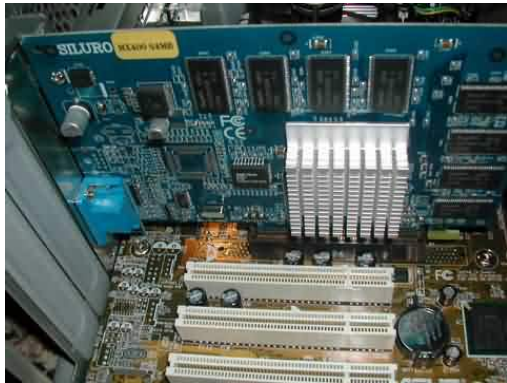
ნახ. 7.6. კომპიუტერში დაყენებული ვიდეოადაპტერი
