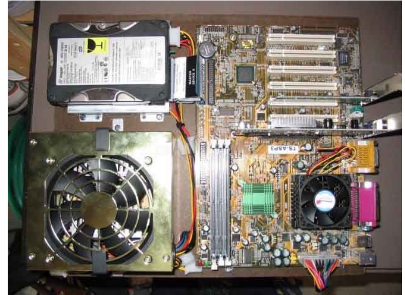
ნახ. 5.15. სისტემური პლატა დაყენებულია კორპუსში არამოხსნადი პანელით
