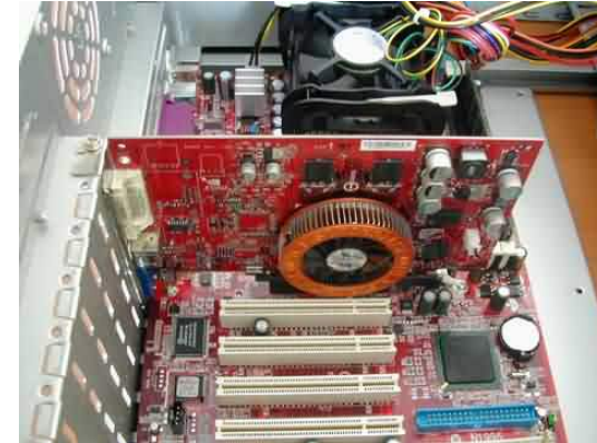
ნახ. 7.7. კომპიუტერში დაყენებული ვიდეოადაპტერი
