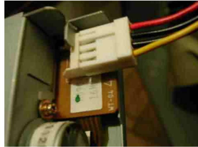
ნახ. 8.8. დრეკადი დისკური მოწყობილობის კვებაში სწორად ჩართული გასართი
