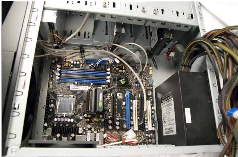
ნახ. 5.14 სისტემური პლატა დაყენებულია კორპუსში მოხსნადი პანელით
