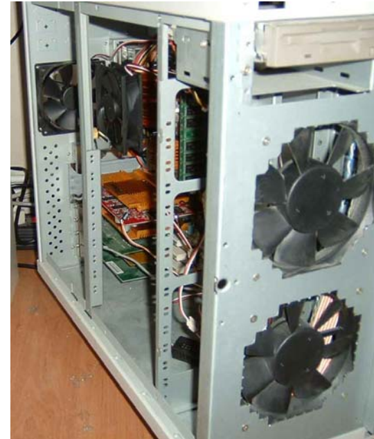
ნახ. 3.3. კორპუსის უკანა მხარეს დამონტაჟებული ფრიალა
