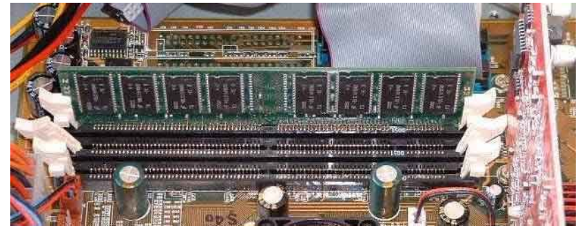
ნახ. 4.5. მეხსიერების მოდული სლოტში დაყენებულია
