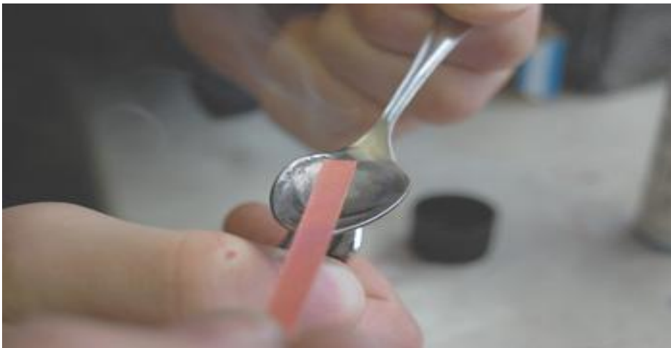
ნახ. 3.2. ზეთის ვარგისიანობის ინდიკატორული პარამეტრების განსაზღვრა: 1. ფუძიანობის რიცხვი
