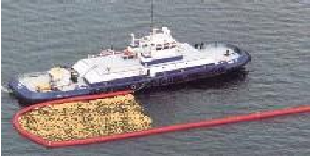
ნახ.6.5. სამრეწველო ბონური ზღუდის გამოყენება ნავთობური კერის ლოკალიზაციის მიზნით
