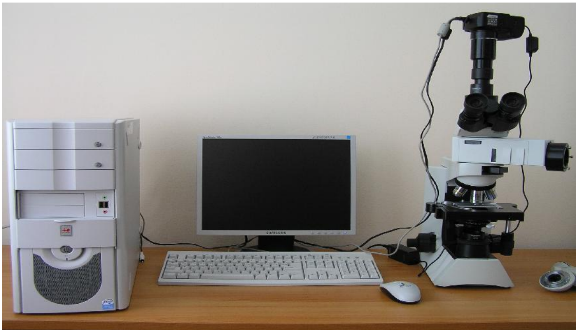
ნახ. 1.1. ქანის გრანულომეტრიული ანალიზი მიკროსკოპული ( 0.002 < d < 0.1 \text{ მმ} ) მეთოდით.
