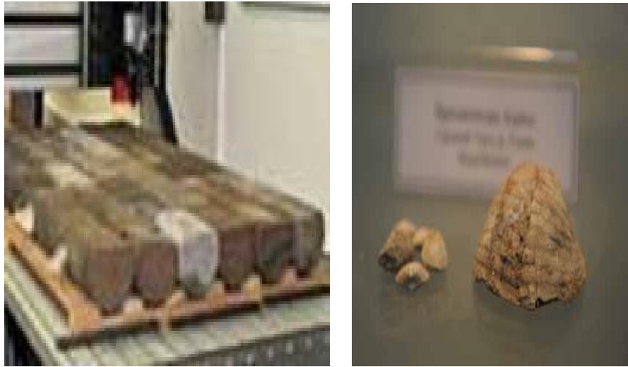
ნახ.2.13. ხის ყუთებში ჩალაგებული კერნის ნიმუშები.
