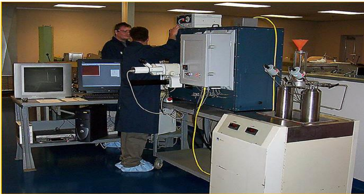
ნახ. 3.1 დანადგარი ფენის პირობებში ფლუიდის ვიზუალიზაციისათვის.
