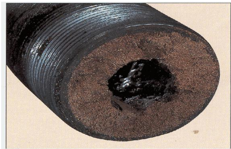
ნახ.4.24. სს მილში წარმოქმნილი ასფალტ ფისოვან პარაფინური ნადები. Asfalto resinoso paraffina sediment
