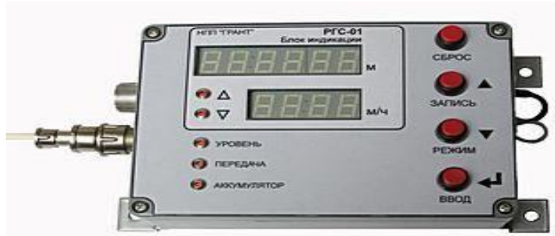
ნახ. 2.11. ჭაბურღილის სიღრმის რეგისტრაციის და ინდიკაციის ბლოკი БИ-01. ინდიკაციის დიაპაზონი-0-9999;მ ინდიკაციის დისკრეტულობა 0.1 მ; სიგნალიზაციის ზღვარი- სიღრმეში- 100---9000 მ
