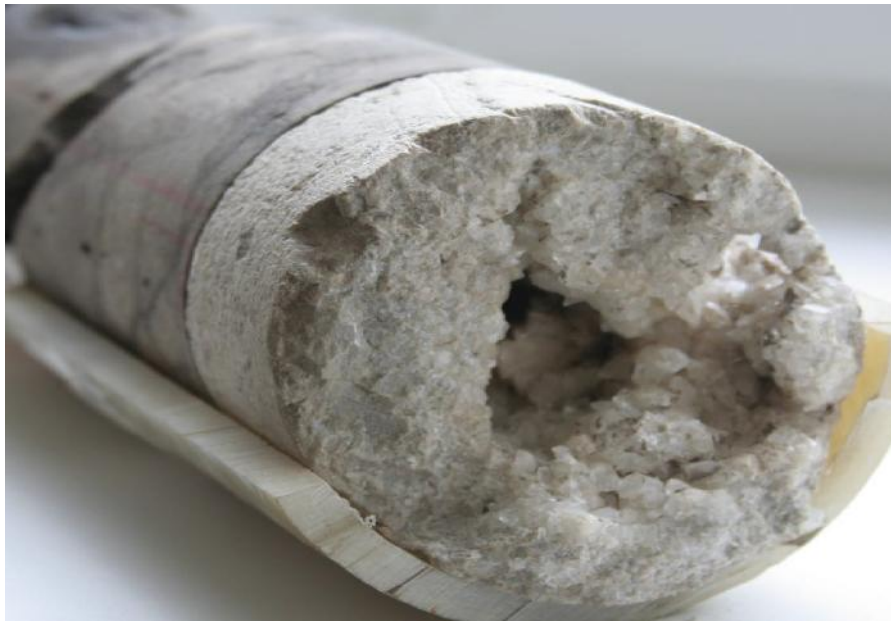
ნახ.4.19. სს მილსადენში წარმოქმნილი მარილოვანი ნადები.
