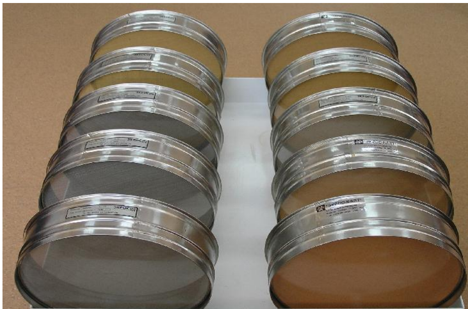
ნახ. 1.3. გრანულომეტრიული ანალიზი საცრული ( d>0.05 მმ.) მეთოდით.
