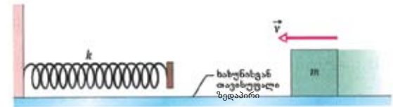
სურ. 7.12. m მასის ყუთი k სიხისტის ზამბარისკენ \vec{v} სიჩქარით მოძრაობს.
