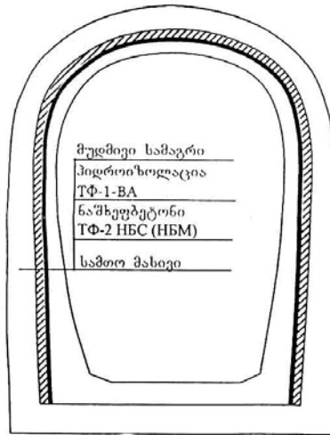
ნახ. დროებითი სამაგრისა და ჰიდროიზოლაციის მოწყობის ვარიანტი
