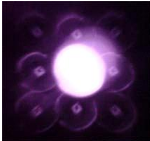
სურ. 5.4. მობილური ტელეფონი Sony Ericsson K810i-ით გადაღებული ინფრაწითელი შუქდიოდის განათებები.
