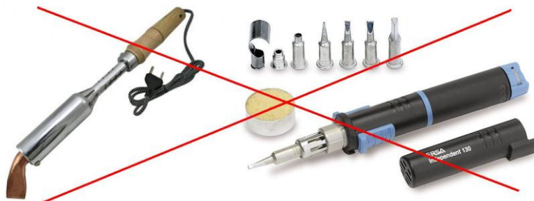
სურ. 2.1. სარჩილავის ტიპები, რომელთაც არ იყენებენ ელექტროტექნიკოსები.
