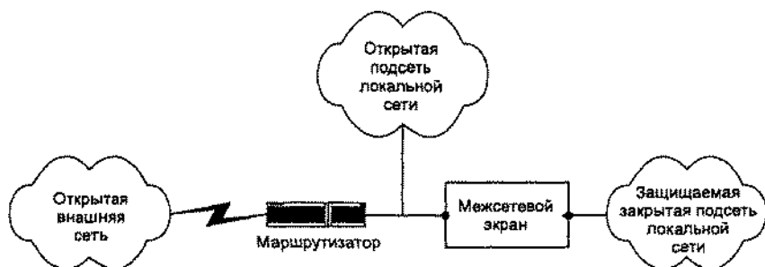
Рис. 9.7. Схема с защищаемой закрытой и не защищаемой открытой подсетями
