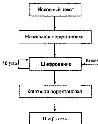
Рис. 6.2. Обобщенная схема шифрования в алгоритме DES
