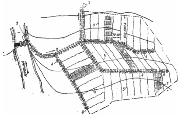
ნახ. 5.1. წყალმიმღები ჰიდროკვანძის და თვითმდენი სარწყავი სისტემის სქემა: 1-წყალსაშვები კაშხალი; 2-წყალმიმღები ნაგებობა; 3-მაგისტრალური არხი; 4-მანაწილებელი არხები; 5-დროებითი სარწყავები; 6-გამომყვანი კვლები; 7-სარწყავი კვლები; 8-ნარგავები არხების გაყოლებით
