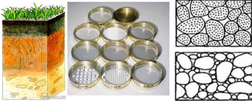
ნახ. N 12. ნიადაგის ჭრილი, ჰორიზონტები, გრანულომეტრიის განსაზღვრის საცერები, ნიადაგის ფორები.
