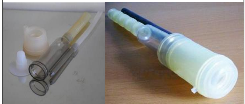
სურ. 143. გამჭვირვალე საწველი ჭიქა დაშლილ და აწყობილ მდგომარეობაში
