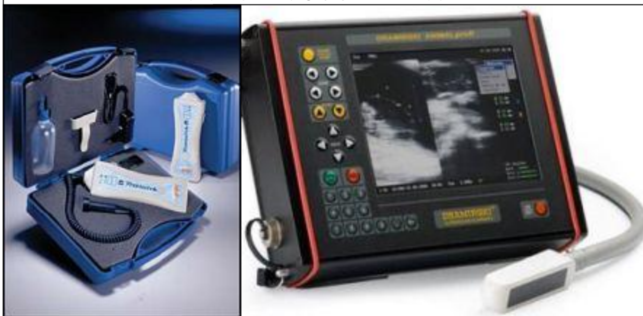
სურ. 52. სასოფლო-სამეურნეო ცხოველების მაკეობის დასადგენი სხვადასხვა მოდიფიკაციის აპარატურა
