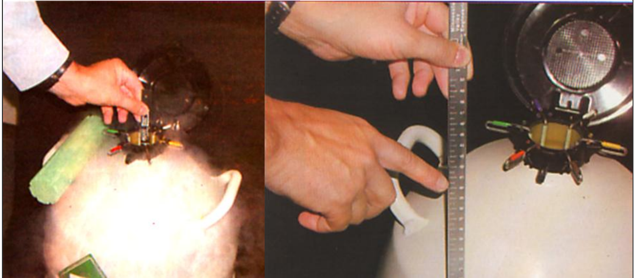
სურ. 234. სპეციალური სახაზავით დიუარის ჭურჭელში აზოტის დონის დადგენა
