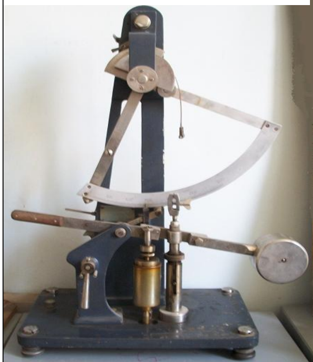
ნახ. 207. მატყლის სიმაგრის დასადგენი ხელსაწყო- დინამომეტრი
