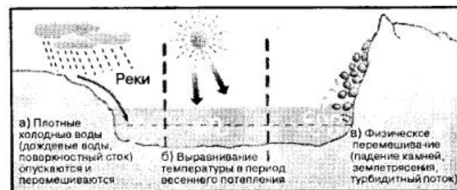
Рис. 2. Разнообразные механизмы, вызывающие переворачивание слоев воды.
