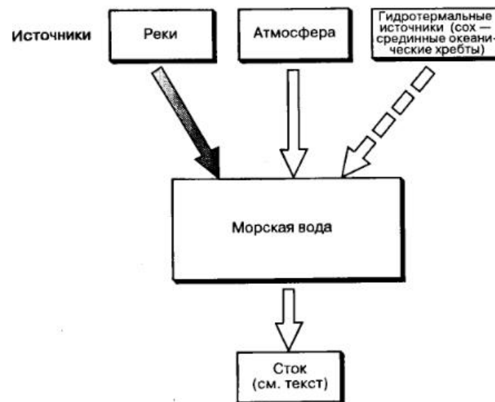
Рис. 4.6. Простая модель, суммирующая приток материала в морскую воду. Размер стрелок соответствует сравнительному значению источника притока.
