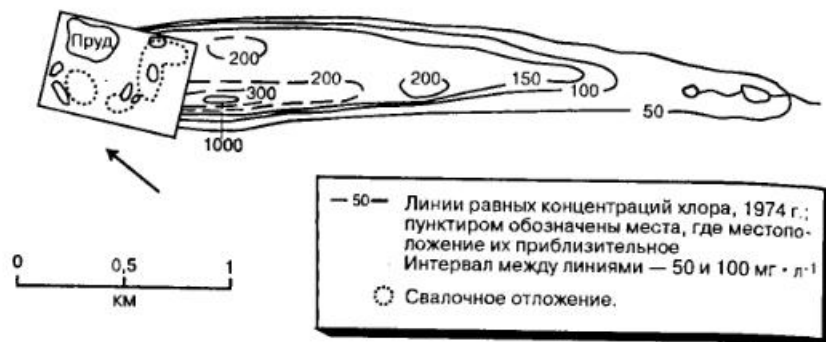
Рис. 3.33. Карта плума \text{Cl}^- на глубине 9–12 м ниже уровня грунтовых вод на городской свалке Вавилона, 1974 г., показывающая степень загрязнения подземных вод. По Kimmel & Braids (1980).
