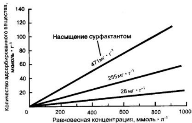
Рис. 3.21. Адсорбция 3-монохлорфенола из воды на смяктит Al_{13} , содержащий различные количества сурфактанта Тергикола 15s-5. По Michot & Pinnavaia (1991).
