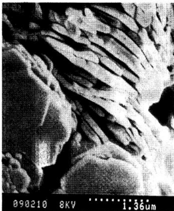
Рис. 3.12. Фотография каолинита, полученная с помощью сканирующего электронного микроскопа, на которой показаны плитчатые кристаллы, собранные в слои. Фотография любезно предоставлена S. Bennett.
