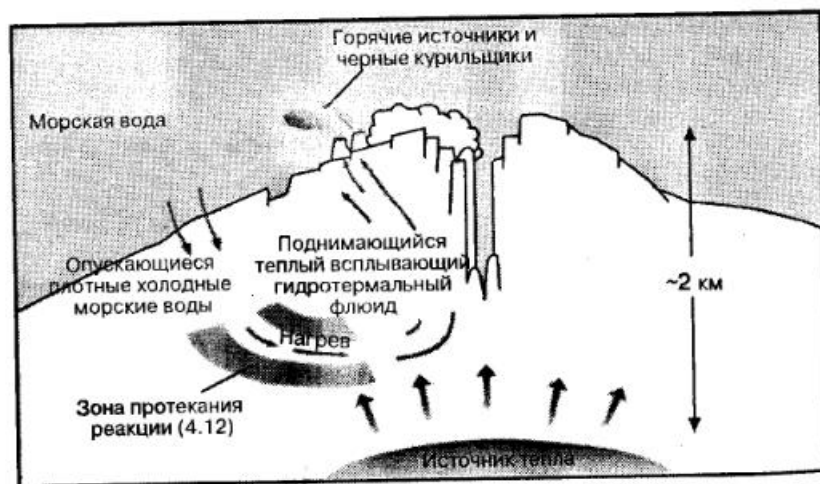
Рис. 2. Гидротермальная конвекция в срединном океаническом хребте.
