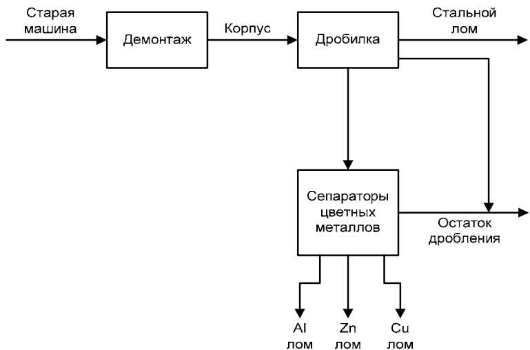
Рисунок 2.4 – Последовательность этапов рециклирования автомобилей
