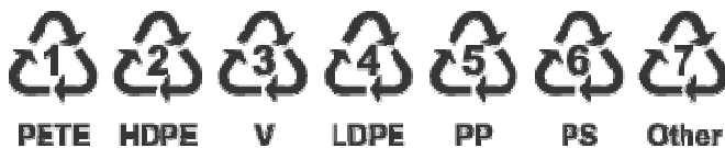
Рисунок 2.6 – Идентификационная маркировка пластиков
