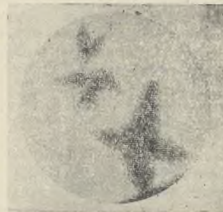
ნახ. 10. გოგირდმჟავას ცივი ხსნარიდან ბარიუმის ქლორიდით სწრაფი დალექვით მიღებული ბარიუმის სულფატის კრისტალი X 10000.
